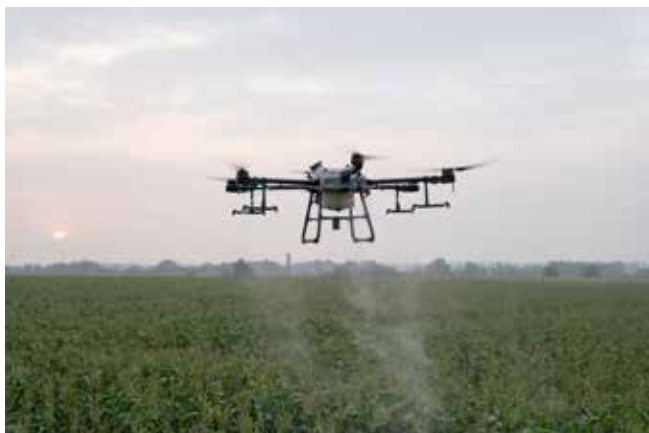
Slika 2. – Dron za tretman useva u radu na tretmanu suzbijanja kukuruznog plamenca ( Ostrinia nubilalis )
