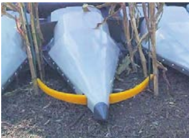
Slika 1. Primjer primjene taktilnog senzora za orijentaciju prema usjevu
