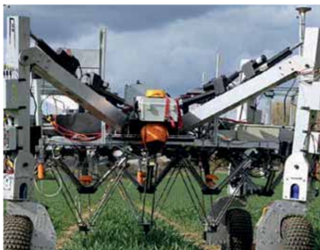
Slika 9. Robot za suzbijanje korova električnim pražnjenjem Dick tvrtke SmallRobot Company
