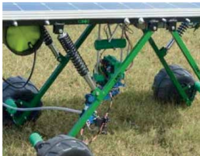
Slika 8. Robot za suzbijanje korova vodenom parom i laserskim uređajem Mapplics GBOT
